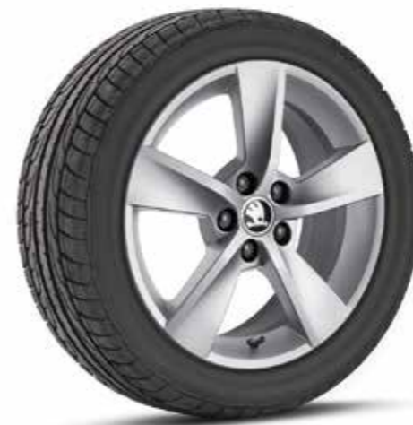
Kola z lehké slitiny ALORE 16" (disk: 7J x 16" ET46, pneu: 215/45 R16)
