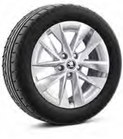
Kola z lehké slitiny ROTARE Aero, 17" (disk: 7J × 17" ET46, pneu: 205/55 R17)
